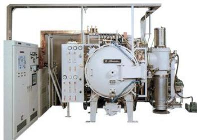
▲真空加圧脱脂焼結炉(島津メクテム㈱)
