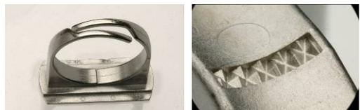
▲研磨による鏡面加工リング部品(左)と表面裂地の極小部品(右)
