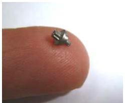
指とギヤ部品：直径 0.60mm
