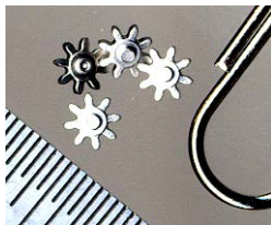
ピニオンギヤ：直径 2.95mm
