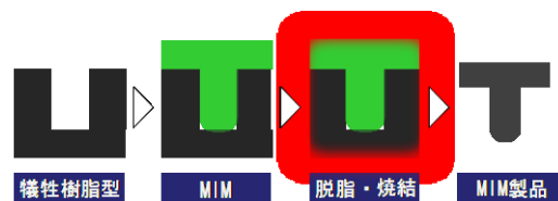
▲ 犠牲樹脂型を利用した成形のプロセス
