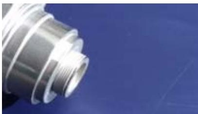
▲チタン合金 MIM の鏡面研磨部の拡大
