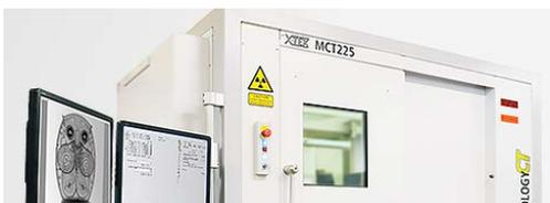
太盛工業で新しく導入したX線CTシステムは、非破壊にて精密部品の内部形状測定、3D スキャニング、精度測定を行うことができる測定システムです。
