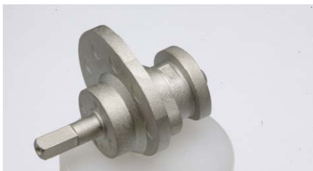
▲一般的な粒径のMIMはパーティングライン等が残る
