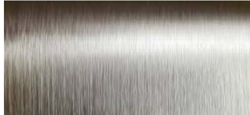
▲ヘアライン加工を施したMIM部品の表面
