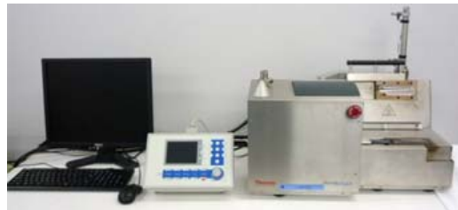
▲ドイツ製 小型樹脂混練・押出成形機
