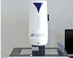
光学式3次元測定機 (スイス製)
