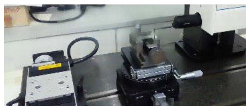
粗さ測定評価の様子
