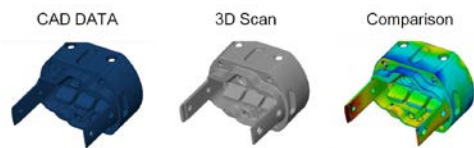
▲ ATOSを使用した測定結果。2つのデータを比較し、評価を行う。
